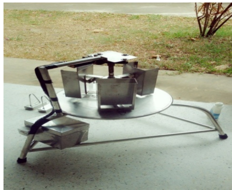
ภาพที่ 4 แสดงตัวเครื่องที่สมบูรณ์ฝานกล้วยทำกล้วยฉาบได้ ทั้งสองลักษณะทั้งแนวตั้งและแนวนอน
