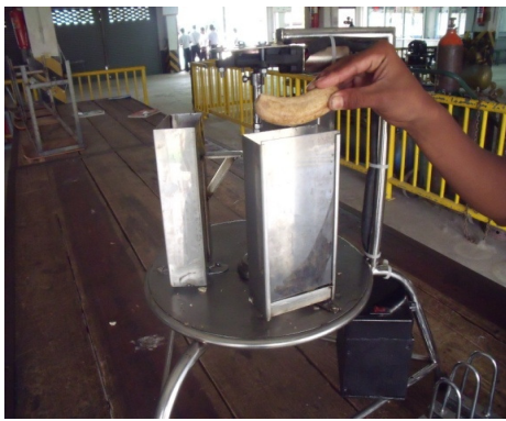
ภาพที่ 2 แสดงลักษณะการวางกล้วยในเครื่องฝานกล้วยฉาบ ในลักษณะแนวตั้ง
