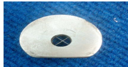
ภาพที่ 6 แผ่นใบมีดสำหรับจักต้นกก
