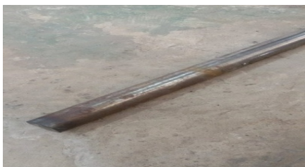
ภาพที่ 1 เหล็กเพลลาตันทำใบมีดจักต้นกก
